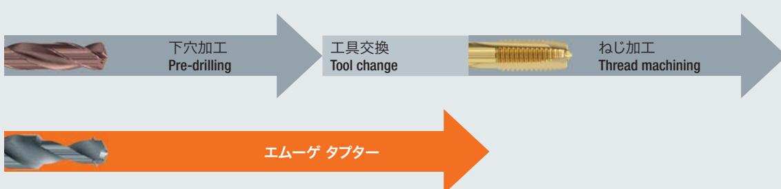
タブターで加工されるねじは DIN ISO 965 準拠の通常のメートルねじになります。ねじの底にはアンダーカット形状が残りますが、その長さは従来のタップの食い付き山に相当するものです。なお、このアンダーカット部にもスクリューをねじ込むことが可能です。
