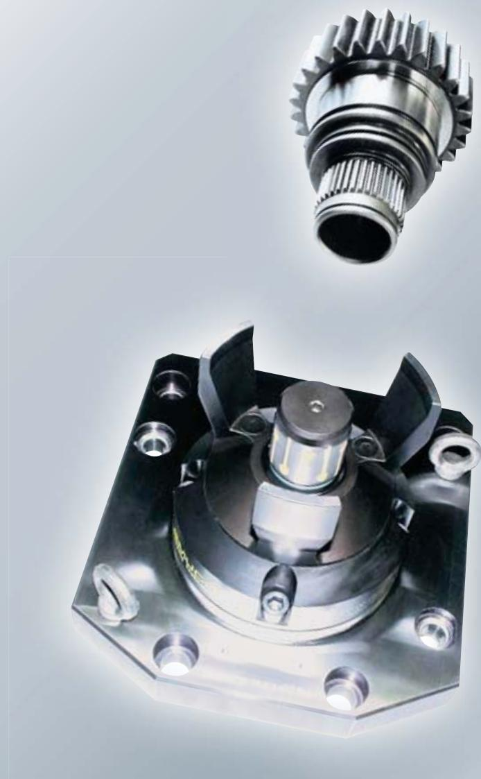
Das Innenschleifen ist ein abtragendes Fertigungsverfahren mit geometrisch unbestimmter Schneide. Die Vorteile des Schleifens gegenüber anderen Arten der Zerspanung sind die gute Bearbeitbarkeit harter Werkstoffe, die hohe Maß- und Formgenauigkeit (IT 5-6) und die geringe Welligkeit und Rauheit ( $R_z = 1-3 \mu\text{m}$ ) der geschliffenen Oberfläche.
