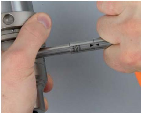
FPC ホルダーの締付けスクリューを時計回りにねじ込むことでクランプが始まります。締付け最大トルクはマーキングされています。
