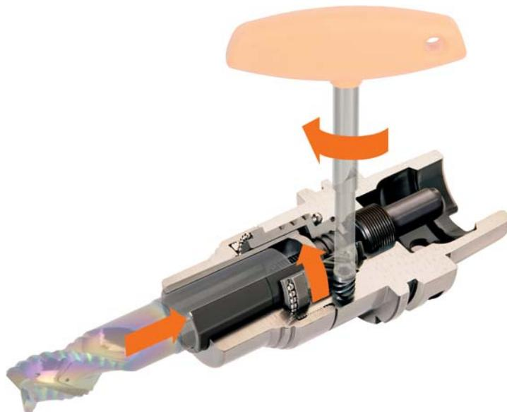
FPC フランケンパワーチャックは 30 kN にもおよぶ引込み力を発生させる 1:16 ウォームギアを内蔵した、たいへんユニークな構造のコレットホルダーです。
