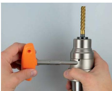
六角キーを締付けスクリューに差し込んでください。六角穴がなめるのを防ぐために、必ずフランケンの専用ドライバーを使用してください。
