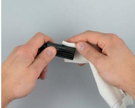
最大級のクランプ力を達成するために、ツールのシャンク、コレットの内外径とホルダー内径を脂脱してください。
