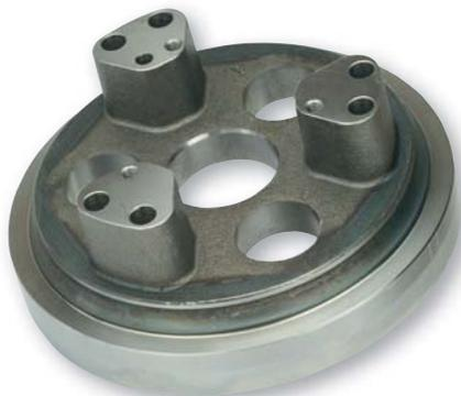
ステンレス鋳鋼部品の外周/穴繰り仕上げ加工
